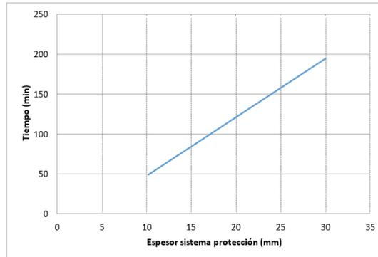
Figura. Gráfico tiempo para aumentar T<sub>carac</sub>, hasta 350°C – espesor protección.
