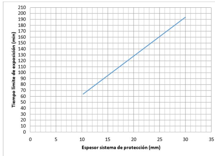
Figura – Espesor del sistema de protección en relación a su tiempo de exposición límite
