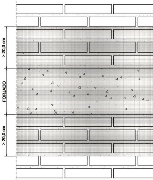
**Fig. 4.** Colocación de la malla (sección)
