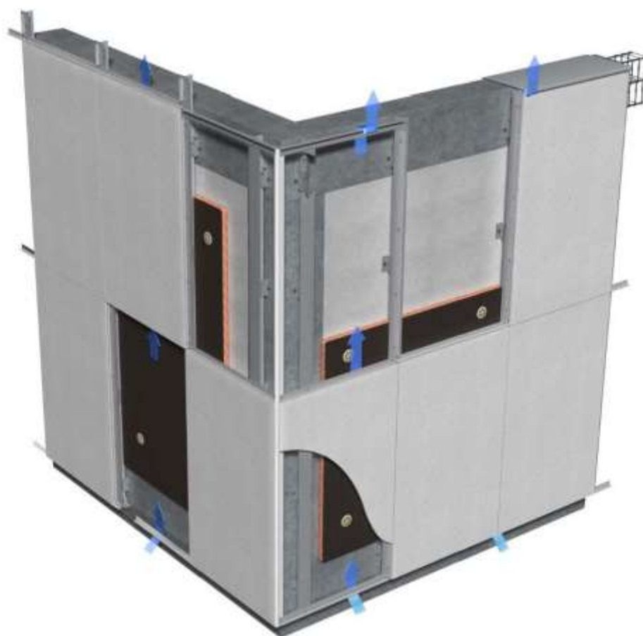
FIGURA 2. CONFIGURACION GENERAL DEL SISTEMA VERTICAL ULMA VANGUARD
