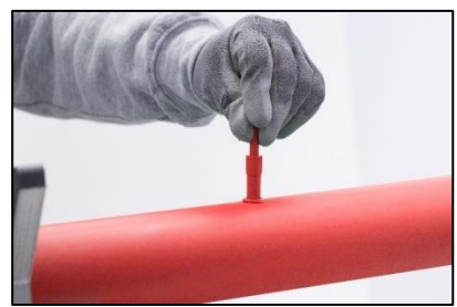
Figura 11. Tapón de reparación en la tubería.
