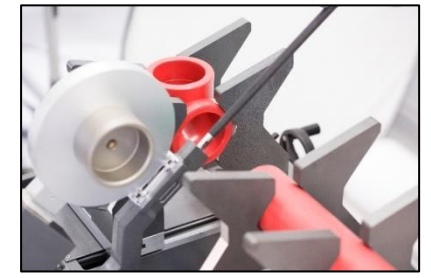
Figura 6. Alineación de tubo y accesorio.
