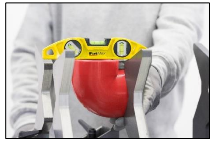
Figura 5. Correcta nivelación de matrices y accesorio.
