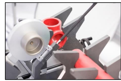
Figura 6. Alineación de tubo y accesorio.
