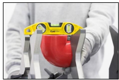
Figura 5. Correcta nivelación de matrices y accesorio.
