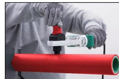
Figura 9. Calentamiento con matriz para derivaciones soldables.
