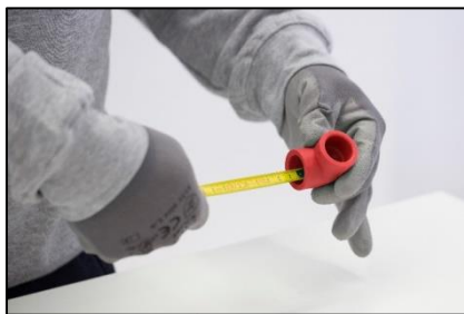
Figura 1. Medición de la distancia de la embocadura.
