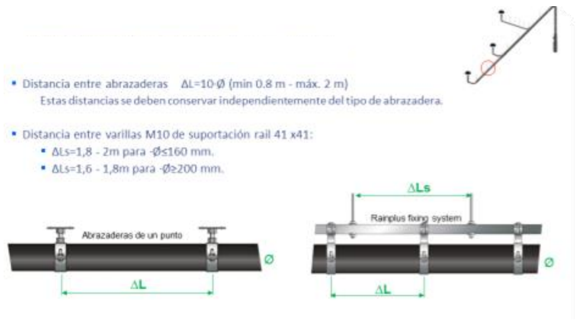
Figura 6. Sistema de fijación estándar y Rainplus®.
